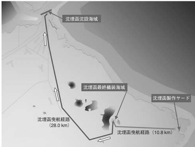
図一〇 沈埋函の曳航ルート
