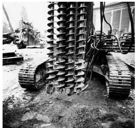
写真—3 米国におけるスラリー系施工機械の紹介例
