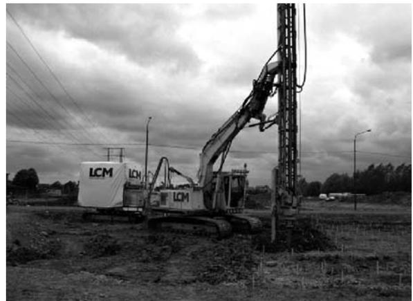
写真—2 北欧の粉体系施工機械の例
