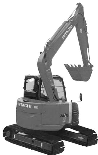
写真一 2 日立建機 ZX75US-3 油圧ショベル (後方超小旋回形)
