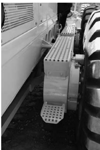
写真-6 スチール製タンデムカバー通路
