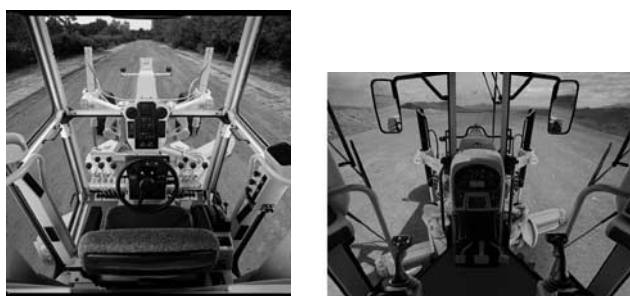
写真—2 従来型キャブ（左）と新型キャブ（右）の視界の比較
