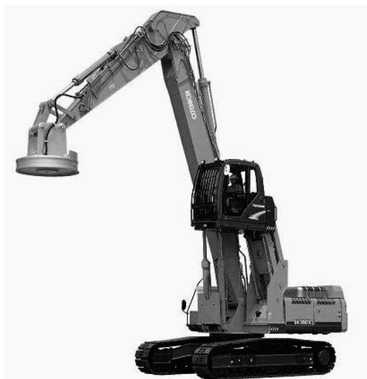
写真-1 ショベルベースのリフティングマグネット仕様機
