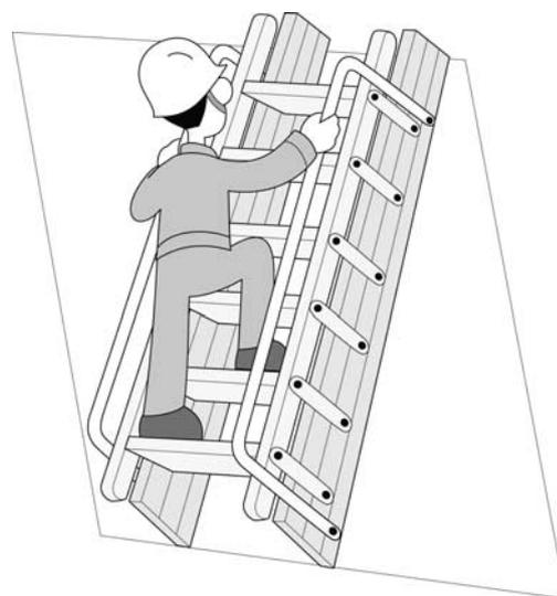
図一 8 階段枠(第2種)の例
