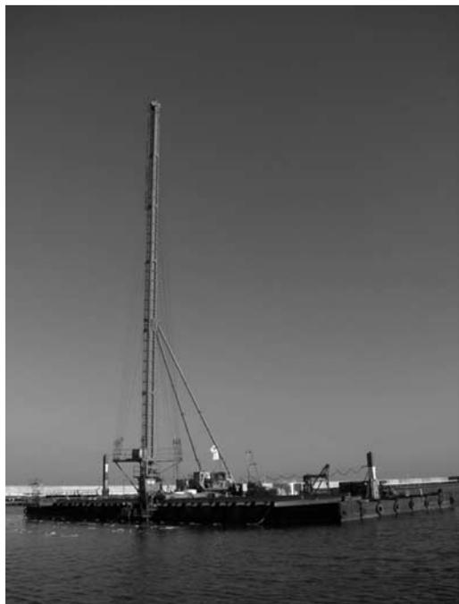
写真一 2 連結フロート式ドレーン打設船
