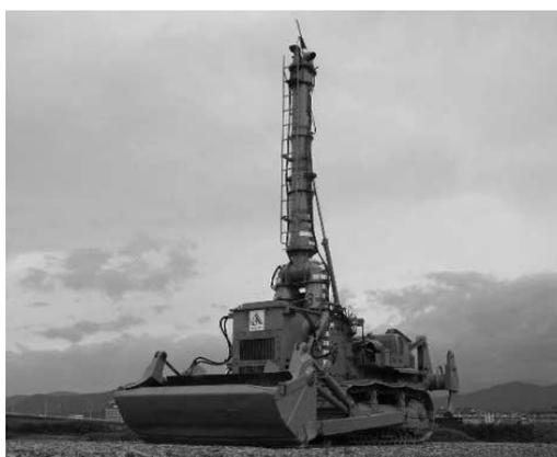
写真—2 D155W-1型水陸両用ブルドーザ
