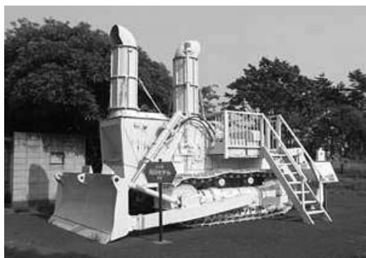
写真—1 D125-18B型水陸両用ブルドーザ
