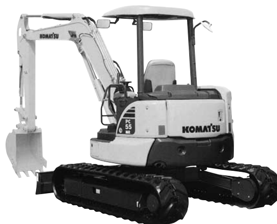
写真-3 コマツ PC55MR-3 ミニショベル（後方超小旋回形）
