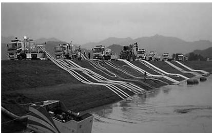
写真二 ポンプ車による緊急排水
