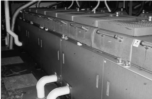
写真-2 クリーンルーム内のステンレス腐食
