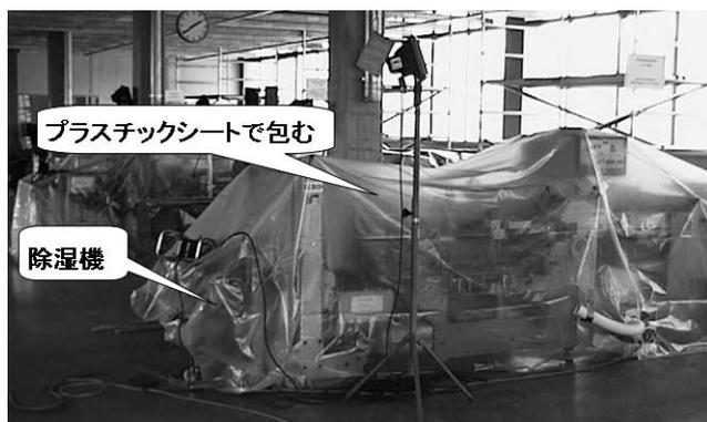
写真-4 汚染した機械の除湿
