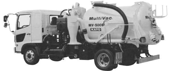
写真-6 加藤製作所「Multi Vac.」MV-500S 側溝清掃車（水封式ブロワ形）
