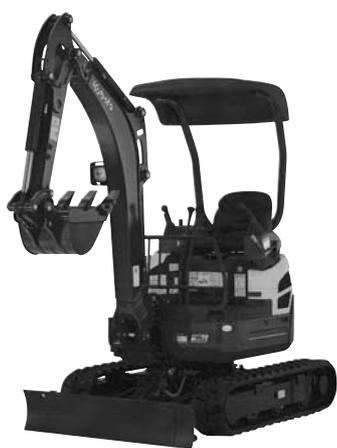
写真一3 クボタ「ZEPH」U-17 ミニショベル(後方超小旋回形)
