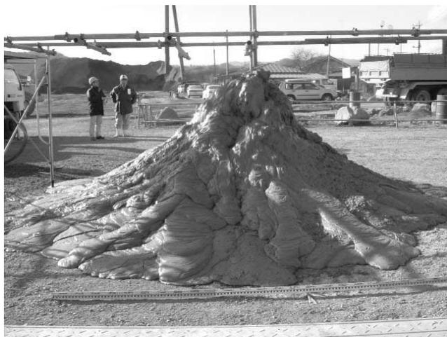
写真—2 試験施工状況（急勾配隔壁形成の確認）
