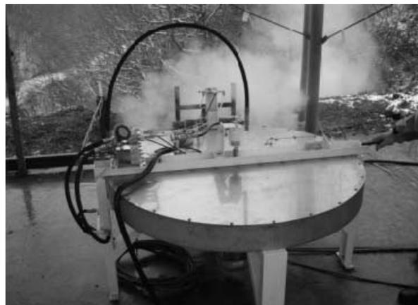
図—8 回転繰返し噴射試験機
