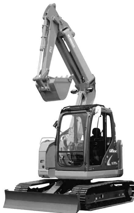
写真一 2 コベルコ建機「アセラ・ジオスベック」SK75SR+油圧ショベル (後方超小旋回形)
