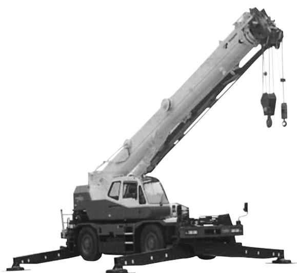
写真一七 タダノ「CREVO 250 G3」GR-250N ラフテレーンクレーン
