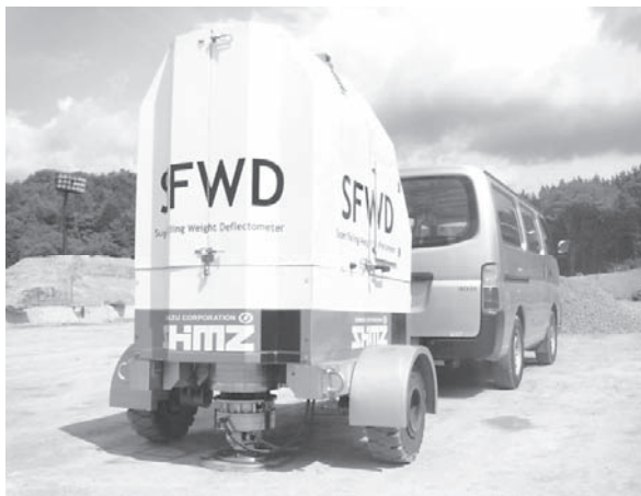
写真—2 SFWDの計測状況
