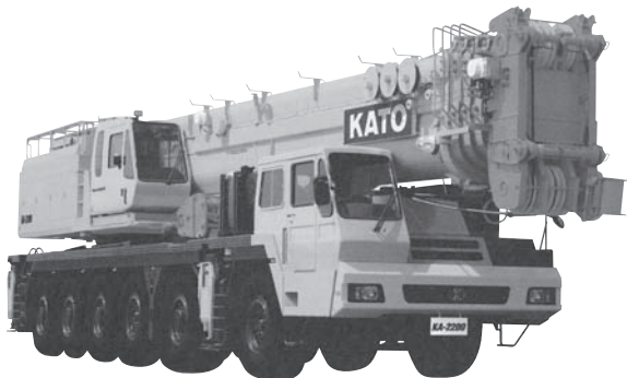
写真一六 加藤製作所 KA-2200 オールテレーンクレーン
