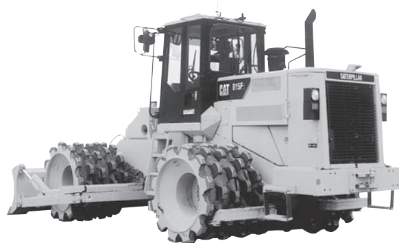
写真—8 キャタピラージャパン CAT 815F2 タンピングローラ
