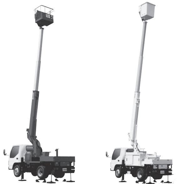
写真一七 アイチコーポレーション 「スカイマスター」 SB10A (左) と SH11A (右) 高所作業車
