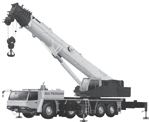
写真一五 タダノ ATF220G-5 オールテレークレーン
