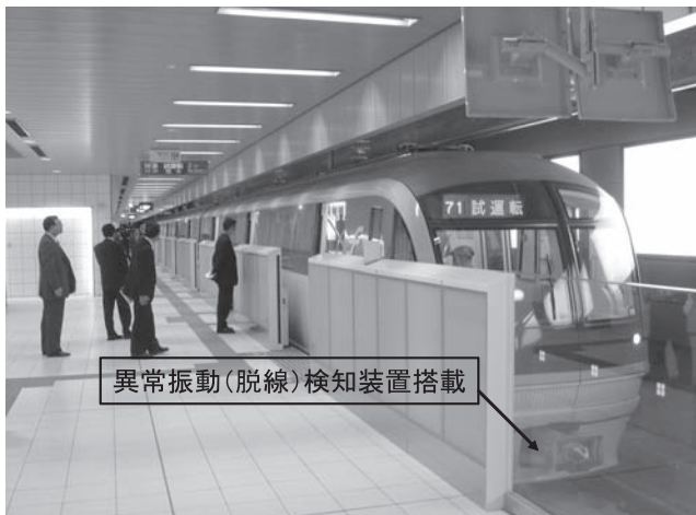
写真一三 日本初の DTO 地下鉄 (福岡市・七隈線)
