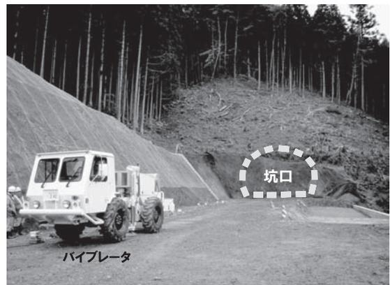
写真-2 トンネル坑外からの探査事例 [パイプレータ震源]
