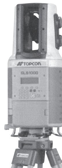
写真一八 トプコン GLS-1000 測量機
