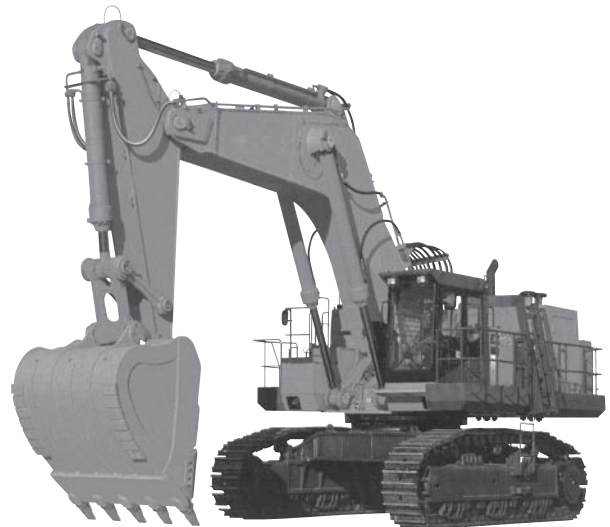
写真-1 日立建機 EX1200-6 油圧ショベル
