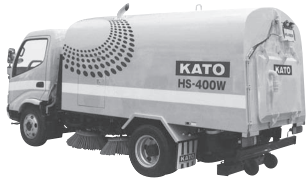
写真一六 加藤製作所 HS-400W 路面清掃車
