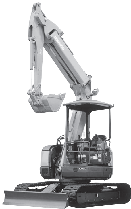
写真一 3 コベルコ建機 [SAVER] SK50UR-5 ミニショベル (超小旋回形)
