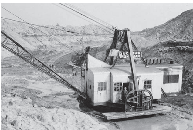
写真-3 1930年代ビサイラス社ウォーキングドラグライン (Coal City Home = Page: http://coalcity.lib.il.us/coalmining/ より転載)
