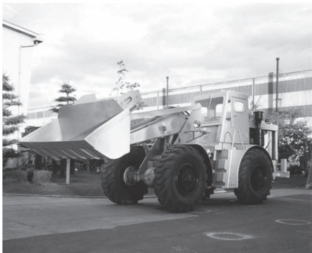
写真—5 1962年米ミキサーモービル社技術導入の川崎重工KLD5ホイールローダ（川崎重工提供写真）
