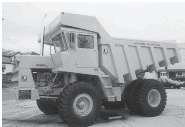
写真—6 1957年ルターナウェスティングハウス社LW32ダンプトラック（コマツアメリカ・ベオリア工場にて撮影）
