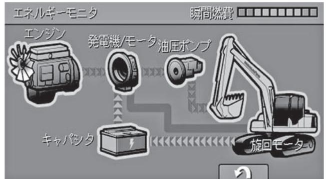
図一12 作業機操作+旋回減速時エネルギーフロー
