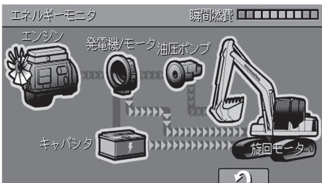
図一11 作業機操作+旋回起動時エネルギーフロー
