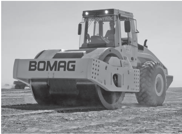
写真—1 BOMAG ポリゴンドラムローラ
