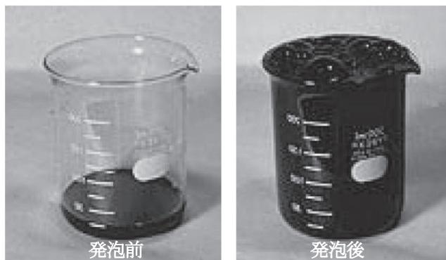
写真-1 フォームドアスファルト発泡状態
