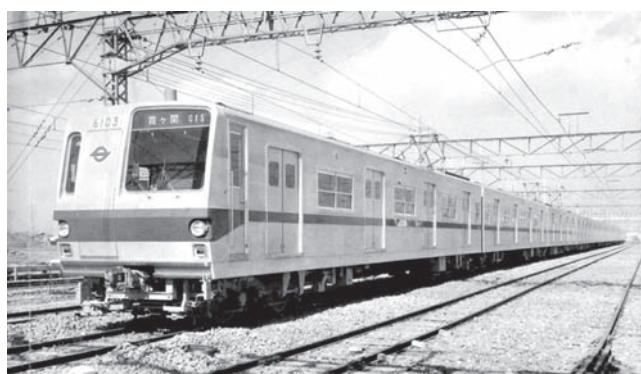
写真—4 営団 6000 形電機子チョップ制御電車
