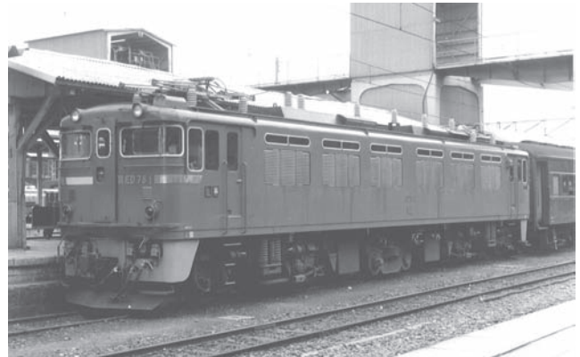
写真一2 ED78 形交流回生ブレーキ付電気機関車 (1968年製造)
