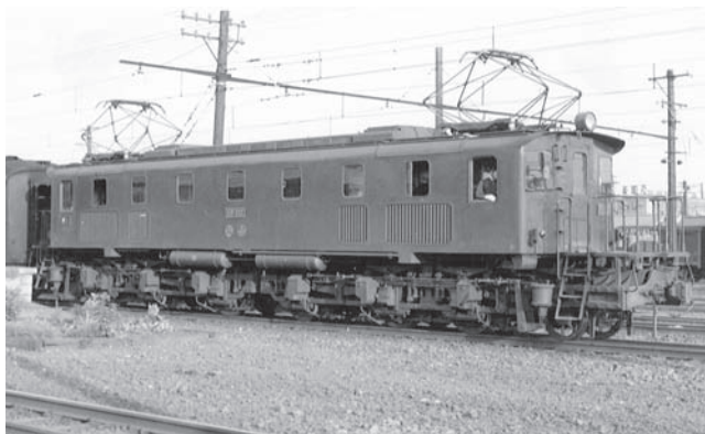
写真一1 中央線 EF11 形直流電気機関車 (1934年製造)
