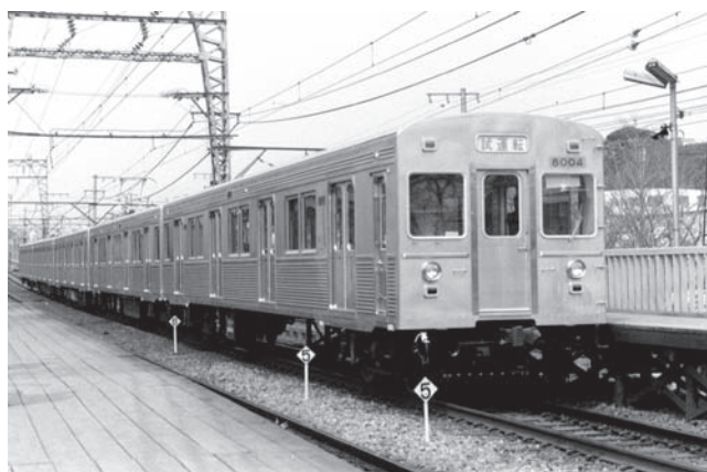
写真—3 東急電鉄 8000 形界磁チョップ制御電車
