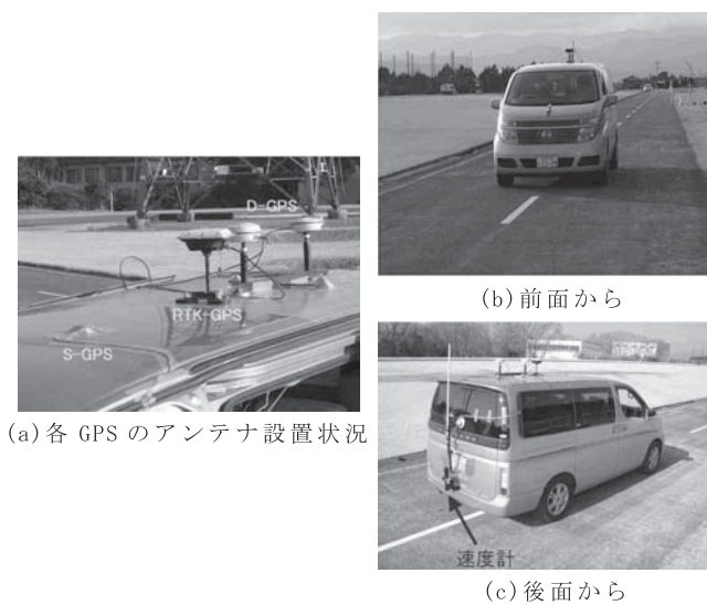
写真一 車両への各 GPS アンテナ搭載状況
