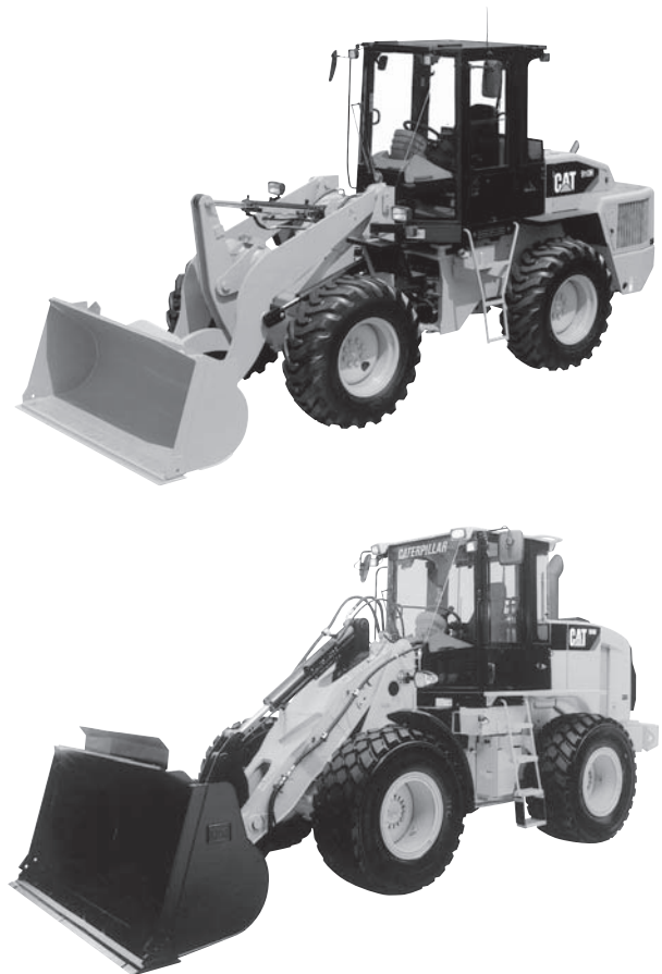
写真—3 キャタピラージャパン CAT910H (上) と CAT924H (下) ホイールローダ
