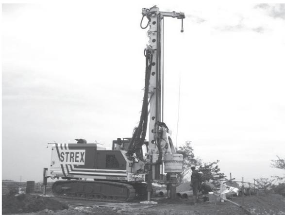
写真-1 STREX 工法施工機械
