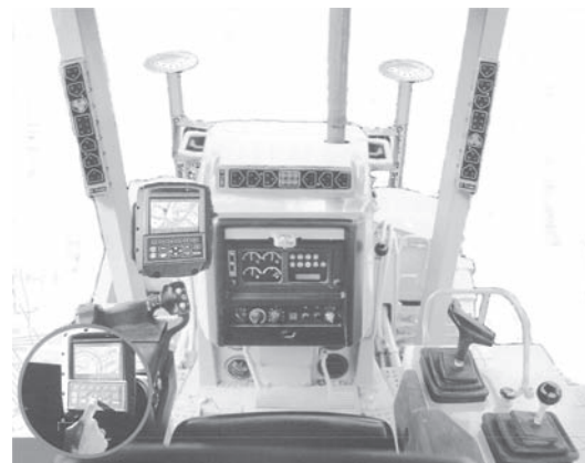
写真3-8 AMGブルドーザの操作レバー指示ディスプレイ
