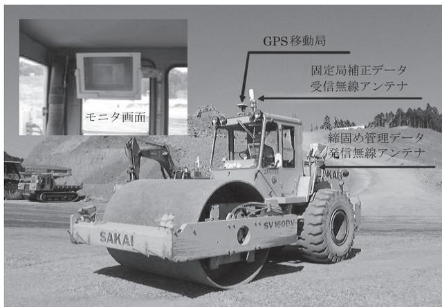
写真—8 GPSを用いた施工状況
