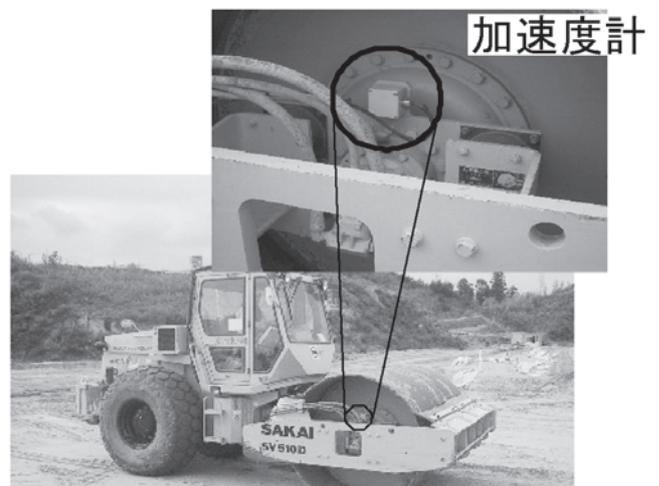
写真—9 振動ローラの加速度計取り付け状況
