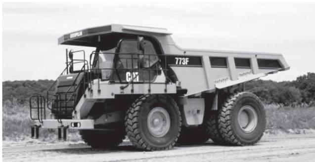
写真-10 斜め階段が標準装備された最新型 46t 積みリジッドダンプトラック
