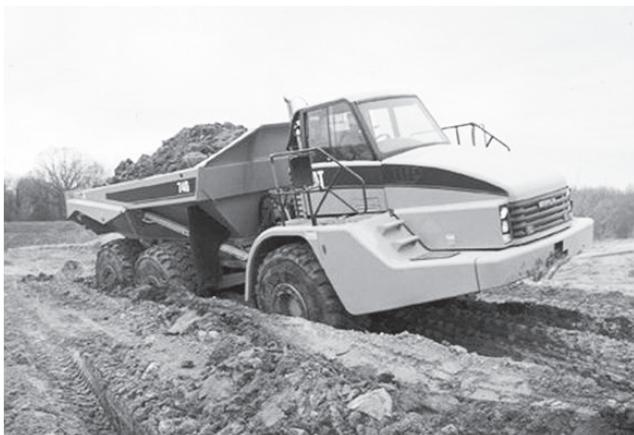
写真—7 最新型アーティキュレートダンプトラックの外観
