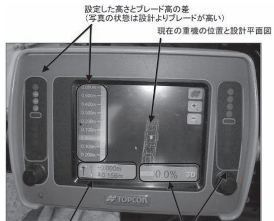
上段: 設計高からの設定オフセット量 設計面の勾配とブレッドのチルト角の差
