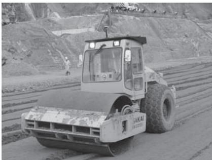
写真一5 GPS 搭載振動ローラー
