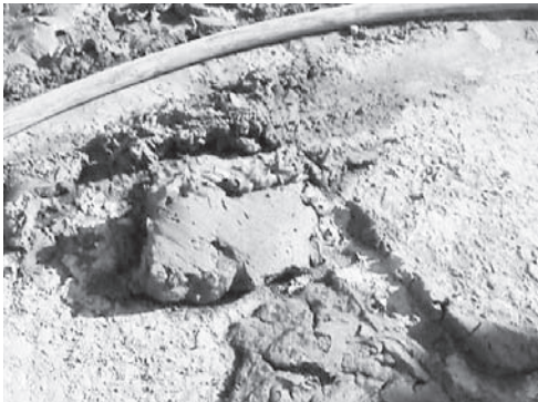
写真—5 粘土状になった汚泥
