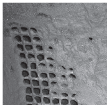
写真一 2 トロンメルへの再生材の付着状況 (140℃)
