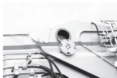
写真一 3 縮小時の油圧駆動式ピン
