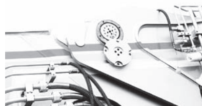
写真一 4 伸長時の油圧駆動式ピン
