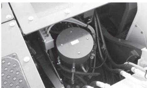
図一2 旋回電動モータ
