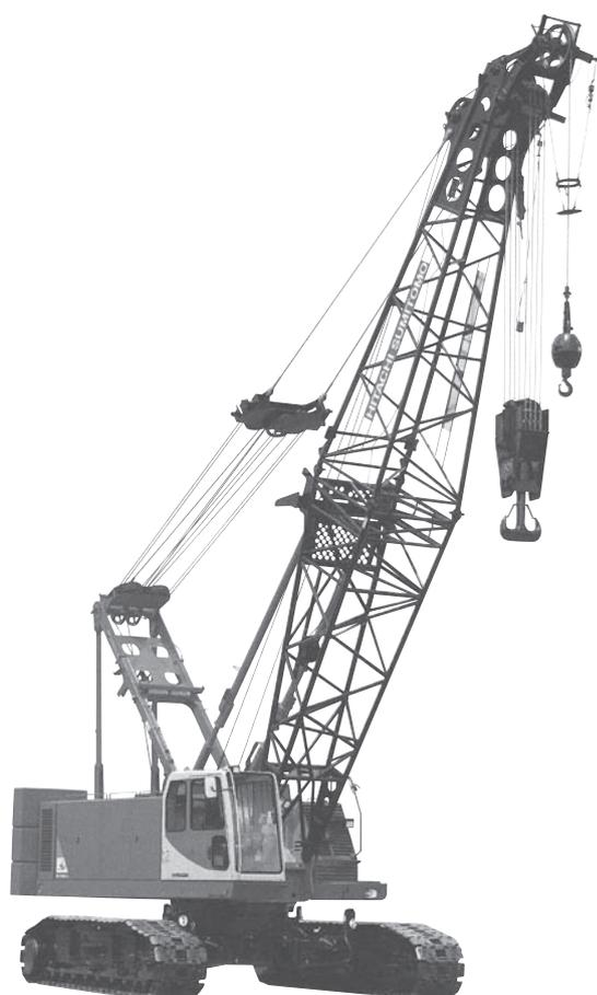
写真-4 日立住友重機械建機クレーン SCX900HD-2 クローラクレーン
