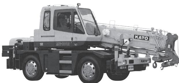
写真一 3 加藤製作所 MR-130R PRELUM ラフテレーンクレーン
