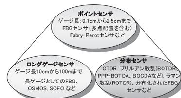
図-1 光センシング手法の分類
