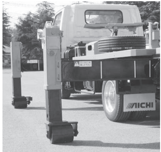
写真-3 走行用ローラジャッキ
