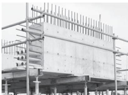
写真一1 空洞やジャンカを再現した実物大試験体
