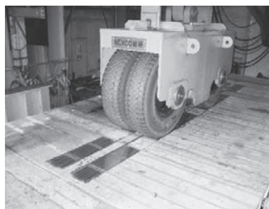
写真—1 移動荷重疲労試験状況
