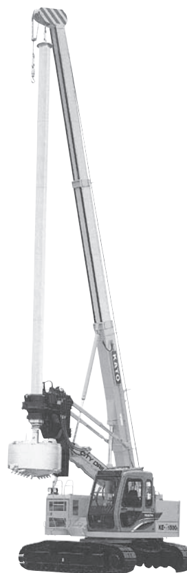
写真一 2 加藤製作所「REGZAM」KE-1500 IIIアースドリル
