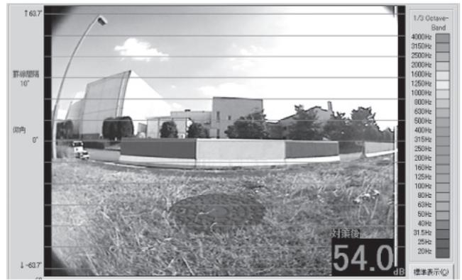
図-8 防音壁設置後の騒音レベル
