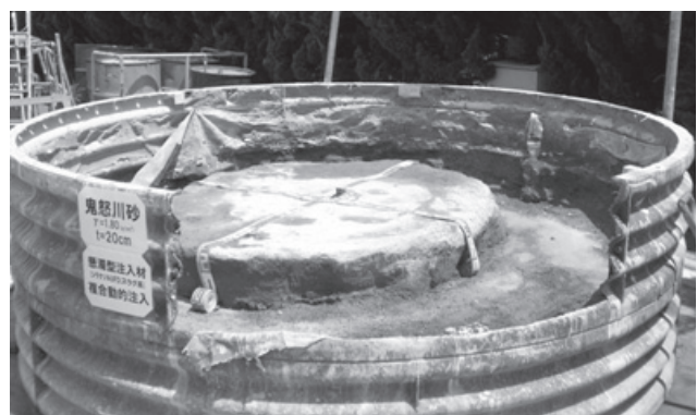
写真—4 複合動的注入による試験結果（改良径：1.9 m）
