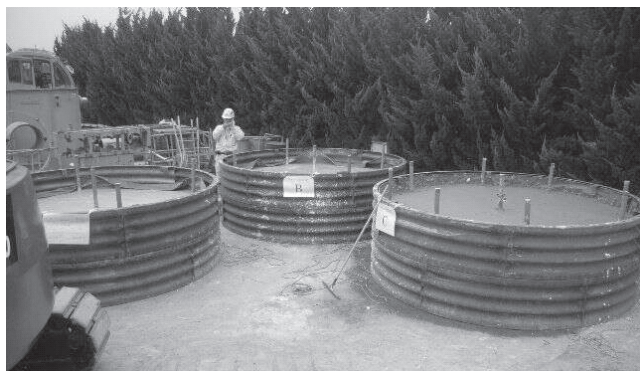
写真—2 砂層（互層）模擬地盤によるモデル試験
