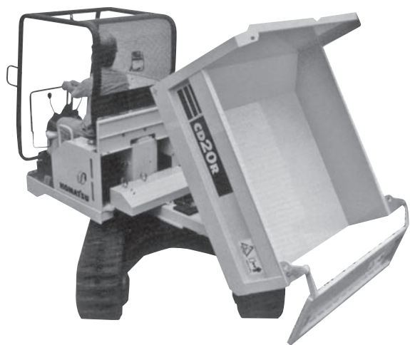
写真一5 コマツ「くるくるダンプ」CD20R-2不整地運搬車(全旋回式)
