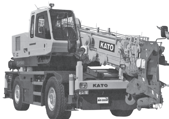
写真一6 加藤製作所 MR-350R PREMIUM ラフテレーンクレーン
