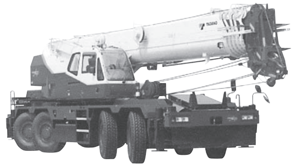
写真—5 タダノ GR-600N (II) ラフテレーンクレーン
