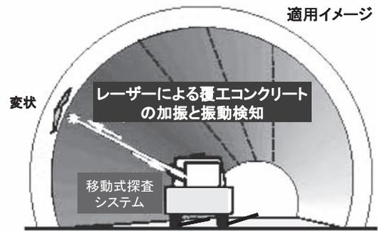
図-2 トンネル覆工コンクリートの欠陥検出イメージ
