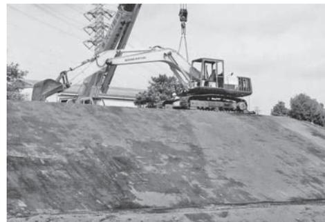
写真-3 転倒姿勢と試験斜面
