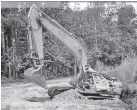
写真-2 転倒後のキャブ損壊の例
