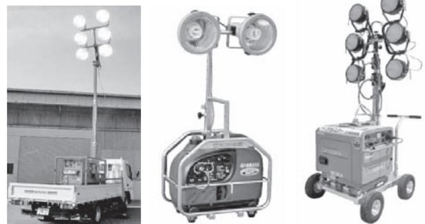
6灯式車載型, ポータブルタイプ, エコセラランプ式
