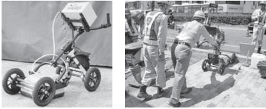
埋設物損傷事故防止対策機 Seeker (シーカー)
