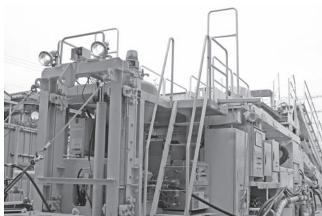
写真-4 バックカメラ・回転灯
