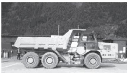
写真—3 アーティキュレート型ダンプ M26C
